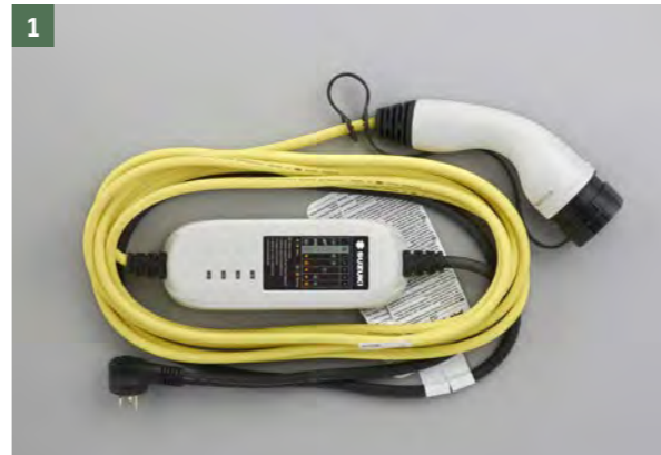
1 | KABEL ŁADOWANIA TYP2 / E/F (230V / 2,3kW) 1, 2 Długość : 7.5m Standard połączenia : Mode2 Gniazdo ścienne : E/F Gniazdo samochodu : Typ2 Parametry elektryczne : 2.3kW 10A Faza-1 Nr kat. 366E0-58U30-000
